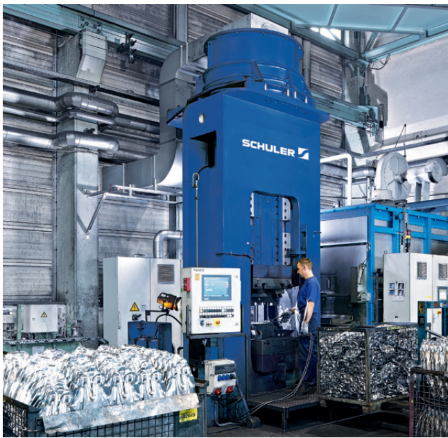
Type PAR 265f screw press for manufacturing aluminum forgings.
