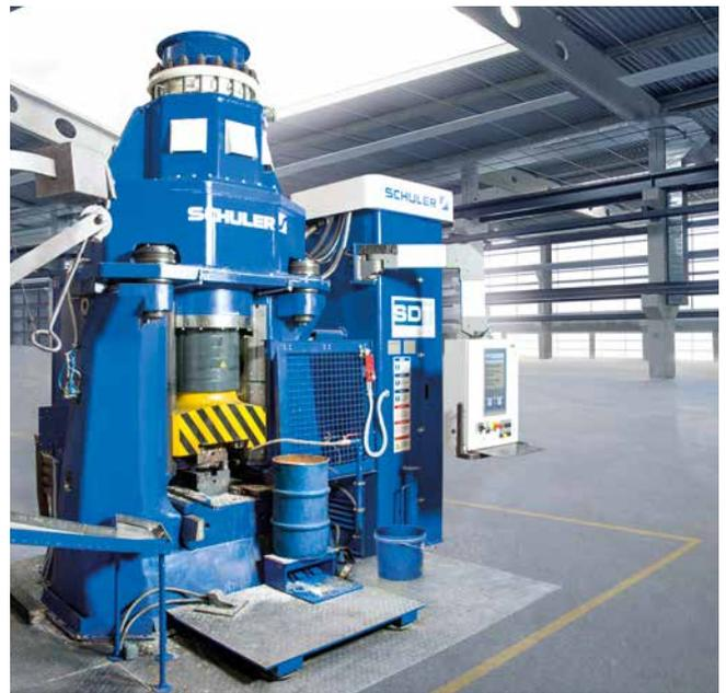
Linearhammer mit ServoDirekt Technologie.
