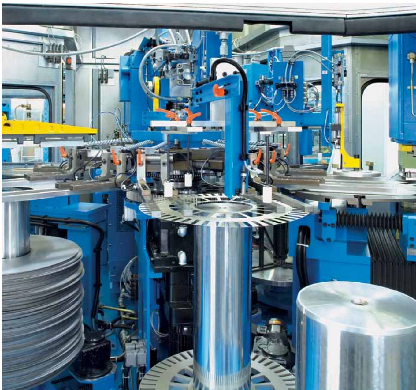
采用环行输送（蜘蛛式）自动化装置的全自动冲槽线。
