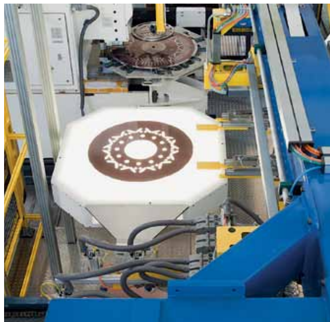
采用线性自动化系统的全自动冲槽线。
