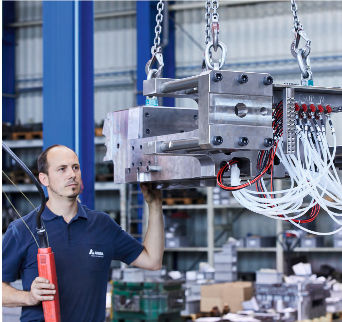
Montage einer Druckgießform Assembly of a die-casting die
