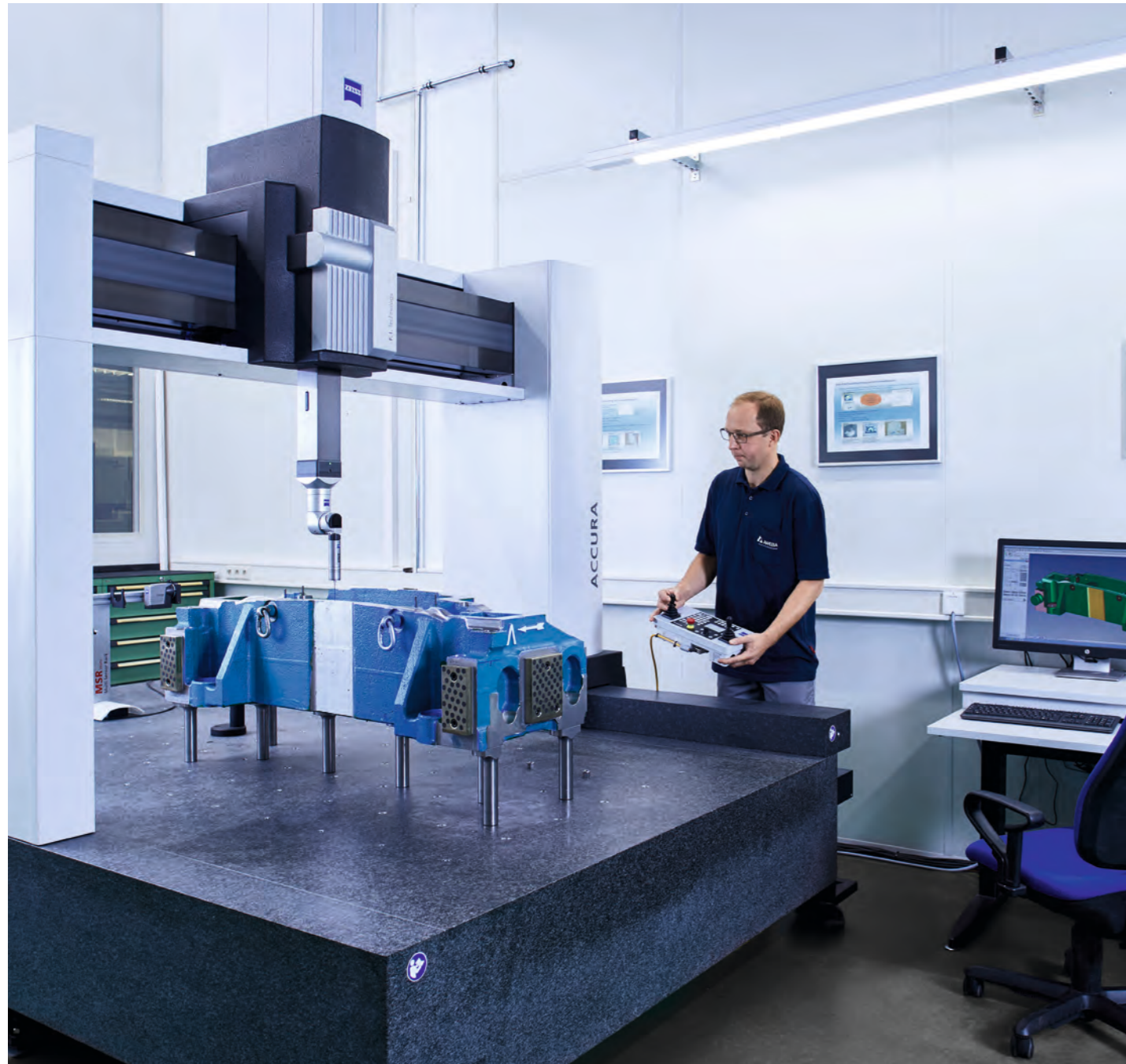
Vermessung einer Werkzeugkomponente an einer Koordinatenmessmaschine Zeiss Accura Measuring a die component using a Zeiss Accura coordinate measuring machine
