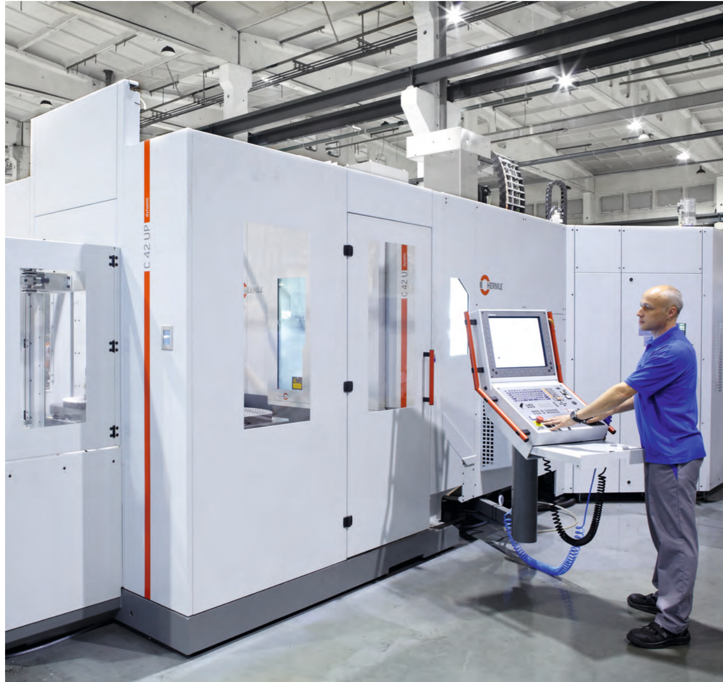
Bearbeitung von Einzelteilen auf automatisierten Fräszentren Individual part machining on CNC machining centers
