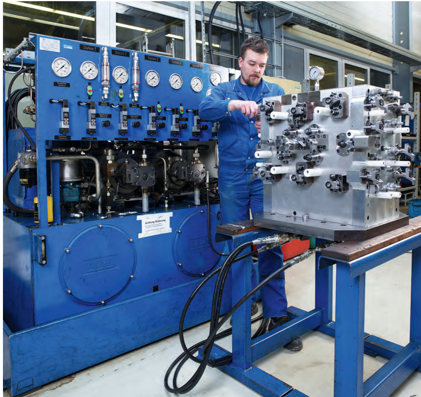
Hydraulische Vorrichtung am Hydraulikprüfstand Hydraulic fixture on the hydraulic test stand
