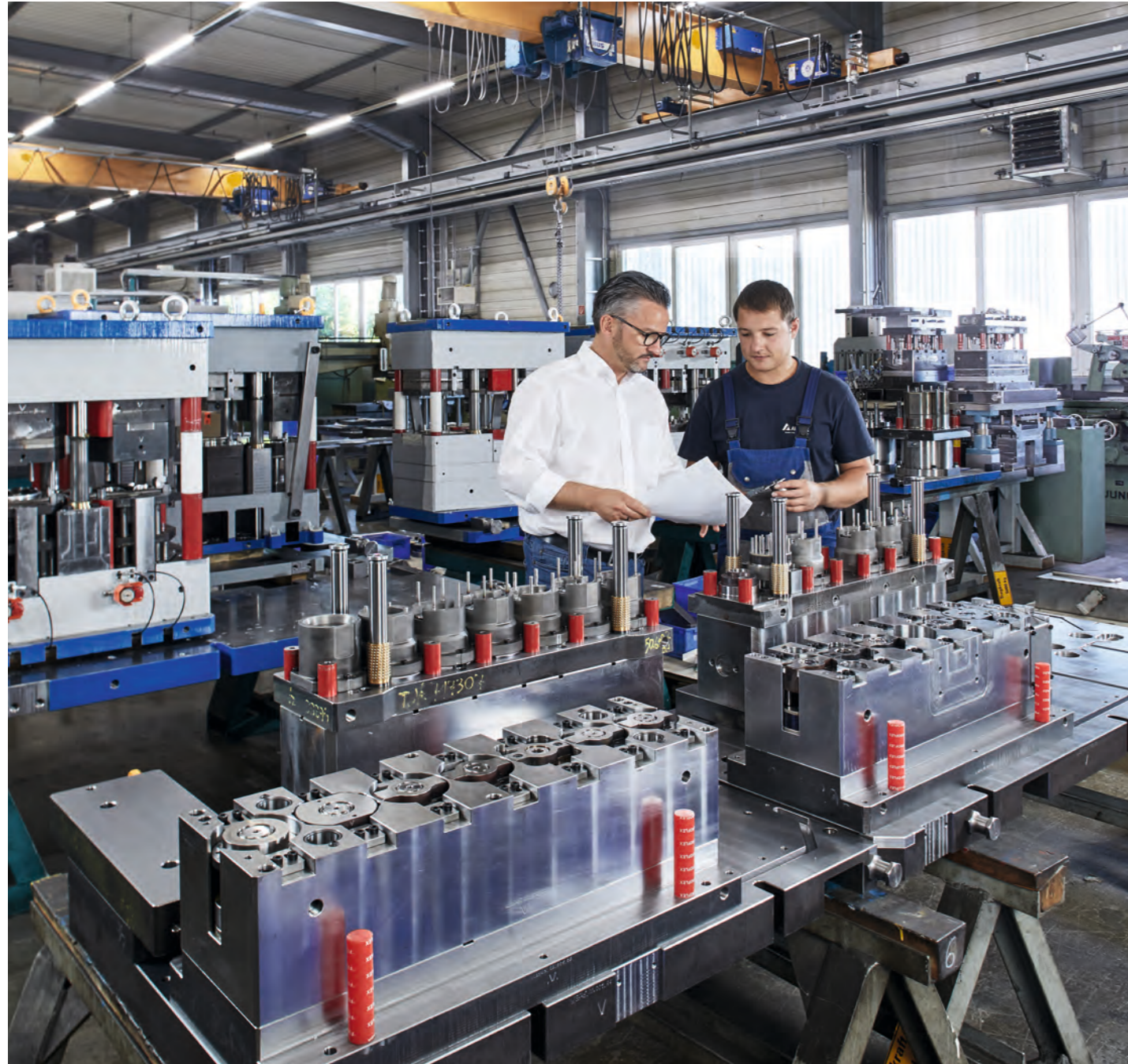
Mehrstufige Ziehwerkzeuge mit erhöhten Umformgraden und Genauigkeitsanforderungen Multiple draw dies with increased strain rates and accuracy requirements
