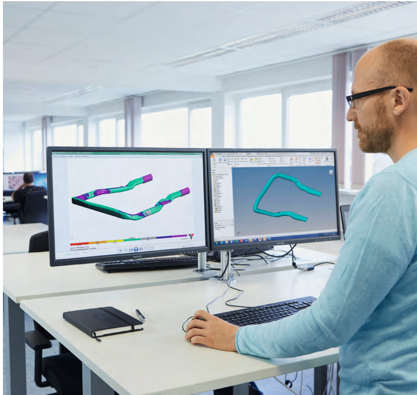
Auswertung der IHU-Umformsimulation eines Motorenträgerbauteils Analysis of the forming simulation – hydroforming of a structural motor part
