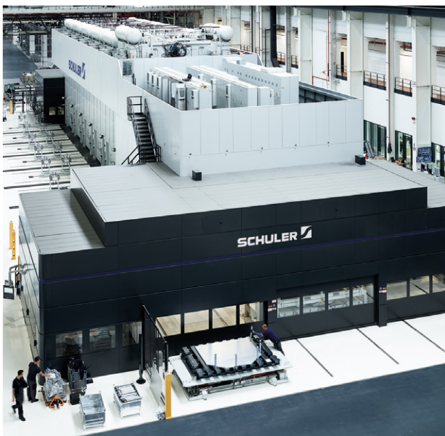
Sechsstufige Pressenlinie mit ServoDirekt Technologie und Crossbar Feeder-Automation.
