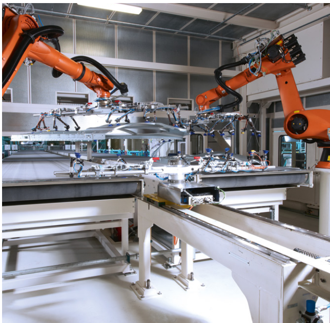
Übergabe der fertigen Bauteile vom Shuttle an Roboter.
