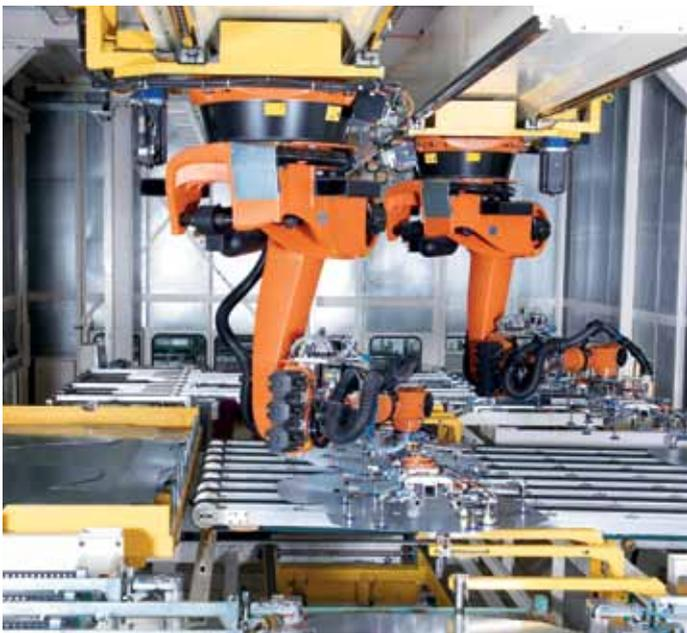
料片拆垛。两个舒勒横杆机器人交替进行料片拆垛，并将其平稳放置在输送带上。
