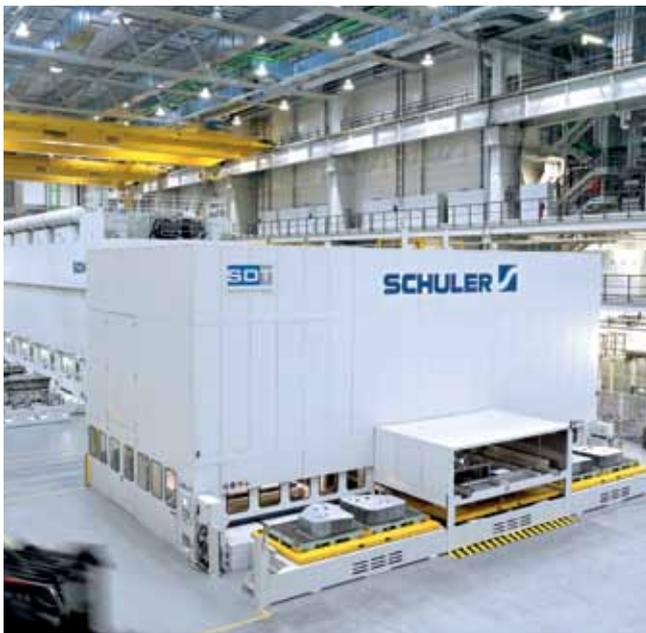
采用伺服直驱技术以及横杆机械手自动化装置的 5 工位冲压线。
