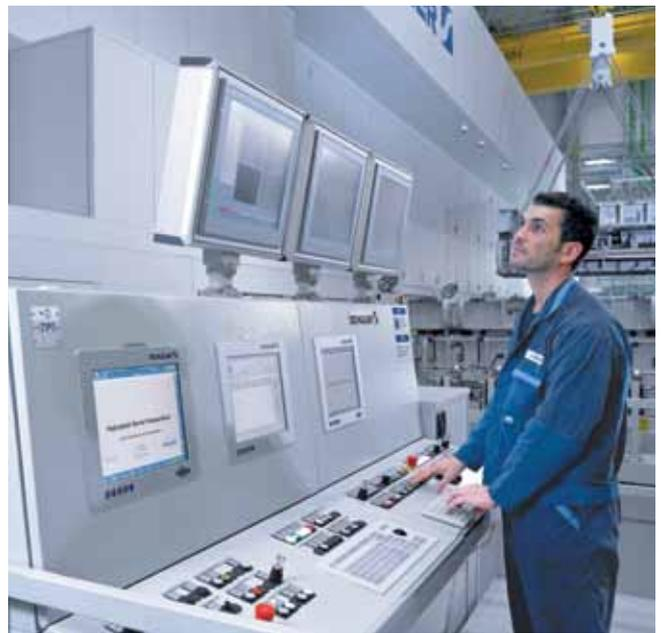
在控制站，冲压线的操作员可以监控整个生产流程。
