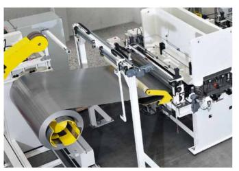
卷材速度测量(如图)和卷材中心与边缘的调节保证精确落料。
