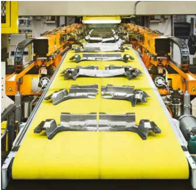
Mit unseren modular aufgebauten Schuler Transfersystemen sind bei einem Retrofit Leistungssteigerungen je nach Ausgangssituation bis zu 50% möglich.
