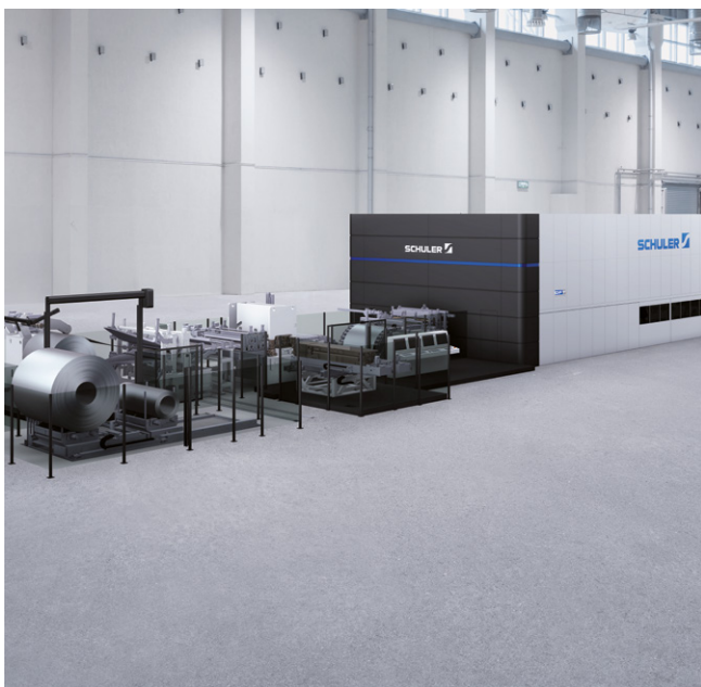
Platinenschneidanlage mit Servopresse.
