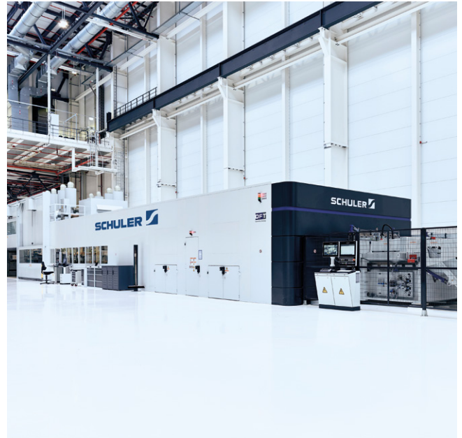
Platinenschneidanlage mit Laserzelle.
