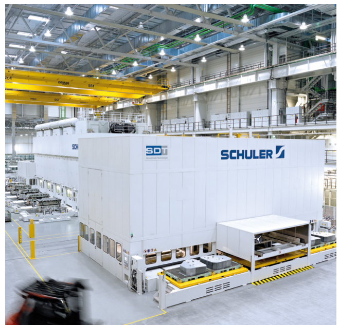
Servopressenlinie mit Platinenlader, Crossbar Feeder-Automation und End-of-Line-System.
