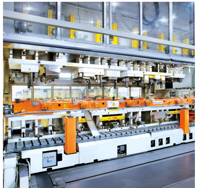
Modularer elektronischer Drei-Achs-Transfer.
