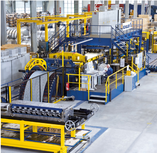
Platinenschneidanlage mit Querteilschere.
