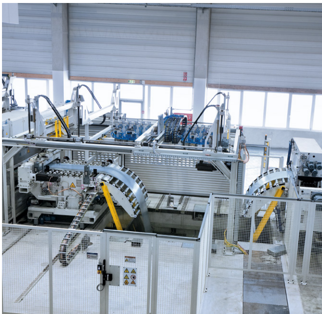
Bandzuführanlage und Platinenlader in Kombination.
