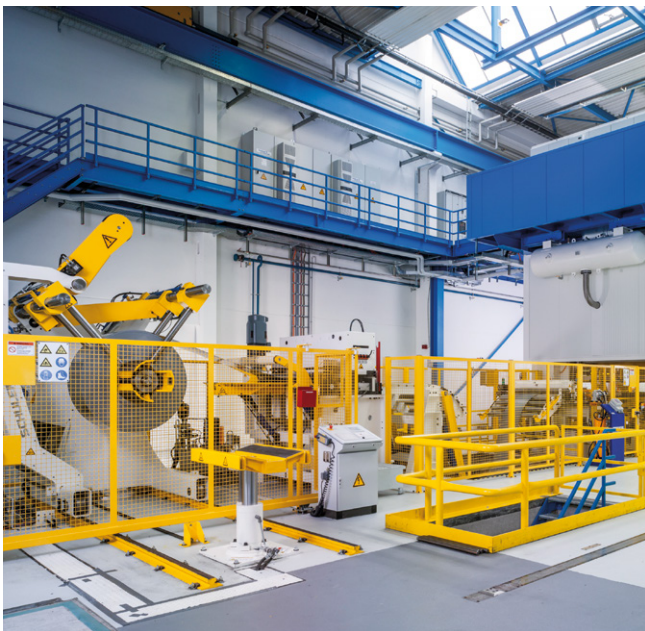
Schneid- und Umformsystem mit Bandzuführanlage der Power Line.
