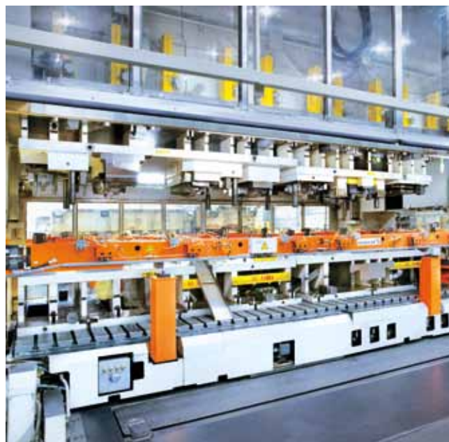
模块化电子三轴输送装置。
