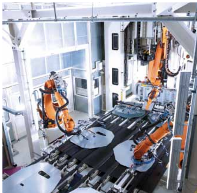
配备了光学对中站的舒勒伺服冲压线中的上料装置。压力机 1 通过横杆机械手上料。
