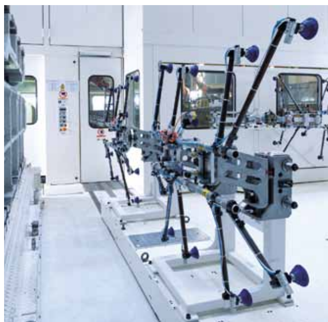
模具和端拾器自动更换装置。
