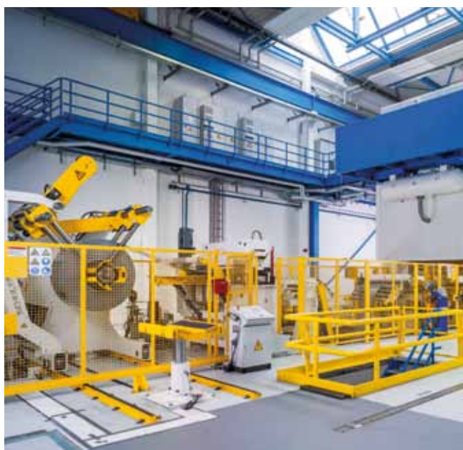
配备了舒勒长空间型开卷线的落料和成形系统。
