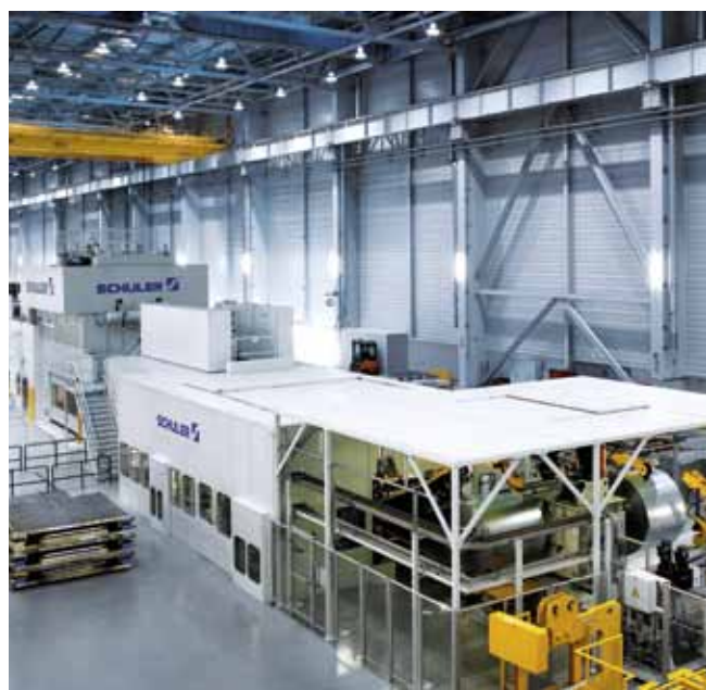
伺服压力机开卷落料线。
