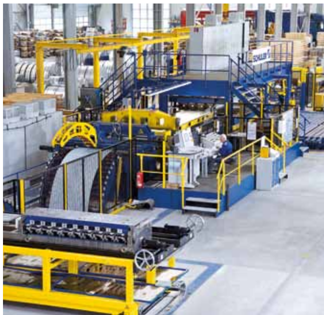
配备纵向剪切机的开卷落料线。
