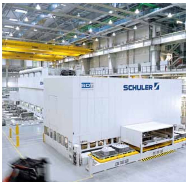
配备了舒勒上料装置、横杆机械手自动化装置以及线尾系统的伺服冲压线
