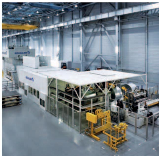
配备压力机的开卷落料线。
