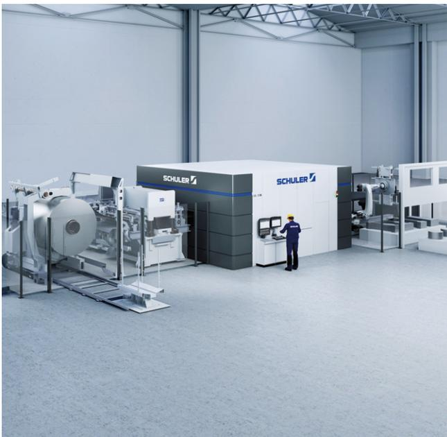
Laserschneidanlage mit einem Laserkopf LBL 1.18 DFT
