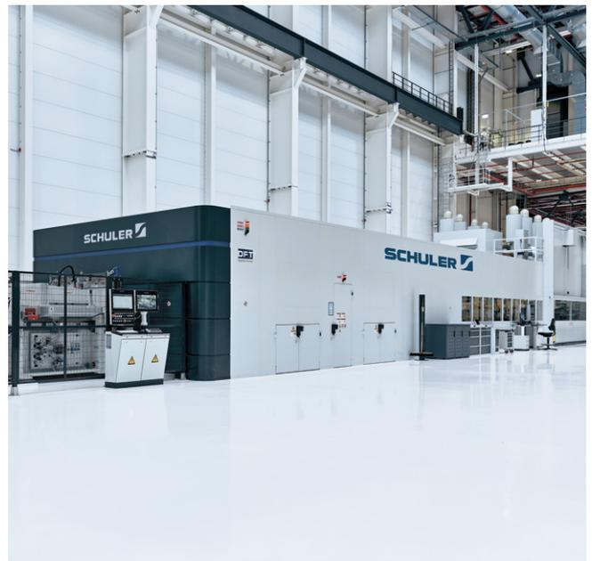
Laserschneidanlage mit zwei Laserköpfen LBL 2.18
