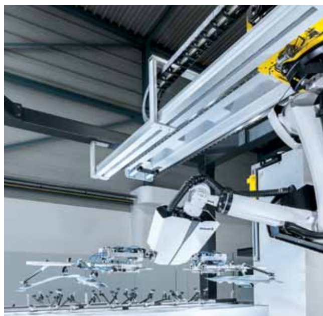
带有创新型工艺数据接口的横杆机器人 4.0。
