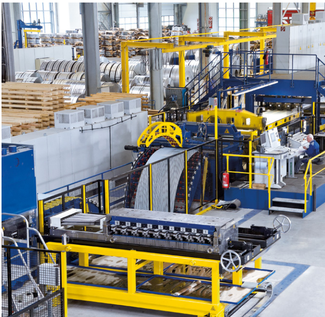
Platinenschneidanlage mit Querteilschere – die Lösung für einfache Schnittformen.
