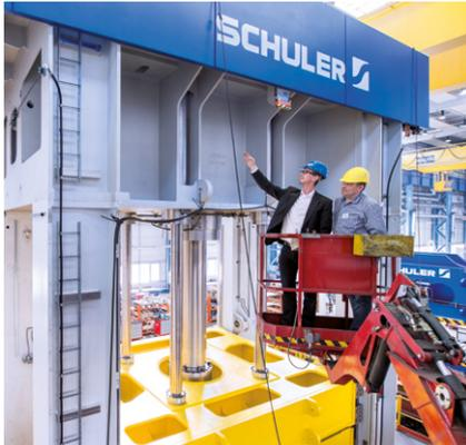
Auf einer hydraulischen Schuler-Presse will ZSKB-Progress Einzelteile für Träger- raketen vom Typ „Sojus“ herstellen.
