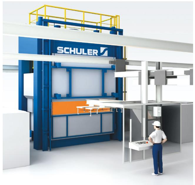
Fertigungszelle mit Heißpresse, Werkzeug-Vorwärmofen und Bauteilmanipulator.
