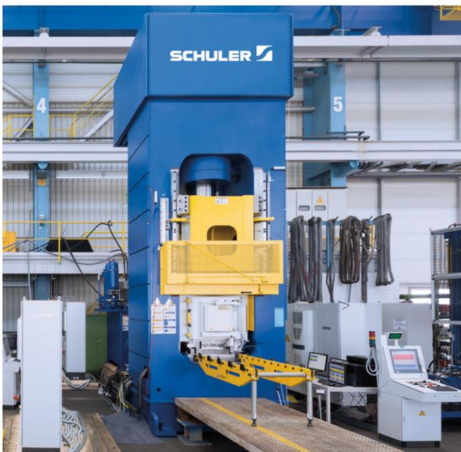
6.300 kN-Isotherm-Umformpresse und Kalibrierpressen mit integrierter Wärmekammer.
