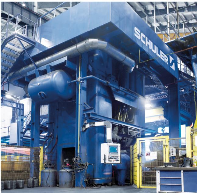
Spindelpresse mit Direktantrieb PZS 900f mit 128.000 kN Presskraft zur Herstellung schwerer Schmiedestücke.
