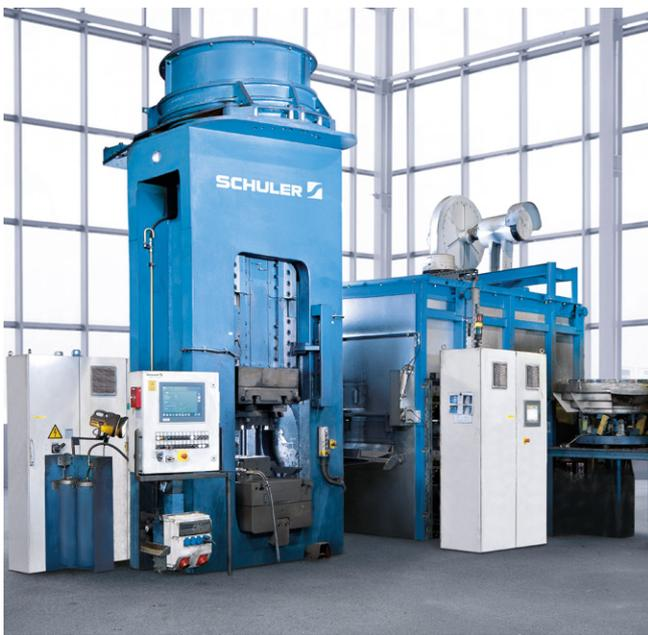
Direkt angetriebene Spindelpresse mit 11.000 kN Presskraft.
