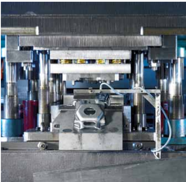
Fabricación en serie con servoprensa de estructura monobloque, fuerza de prensado: 6.300 kN.
