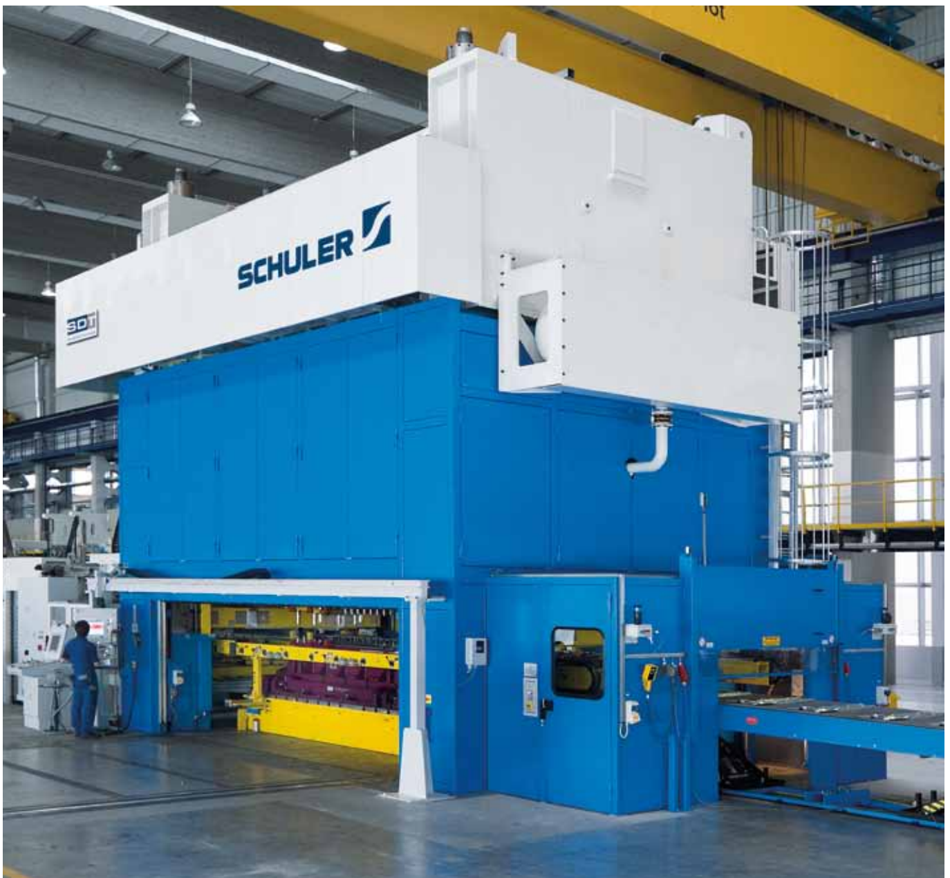
Producción de piezas dobles de un proveedor de la industria de automoción. Fuerza de prensado: 16.000 kN.
