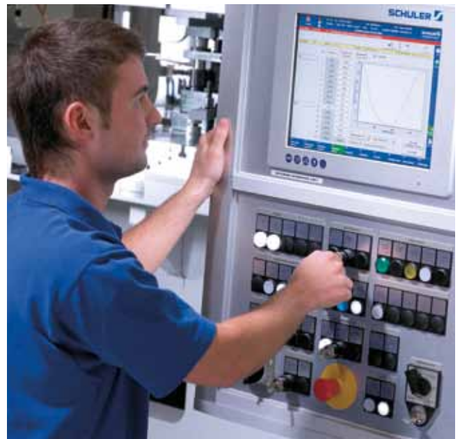
Libre programación de las curvas de movimiento del émbolo.
