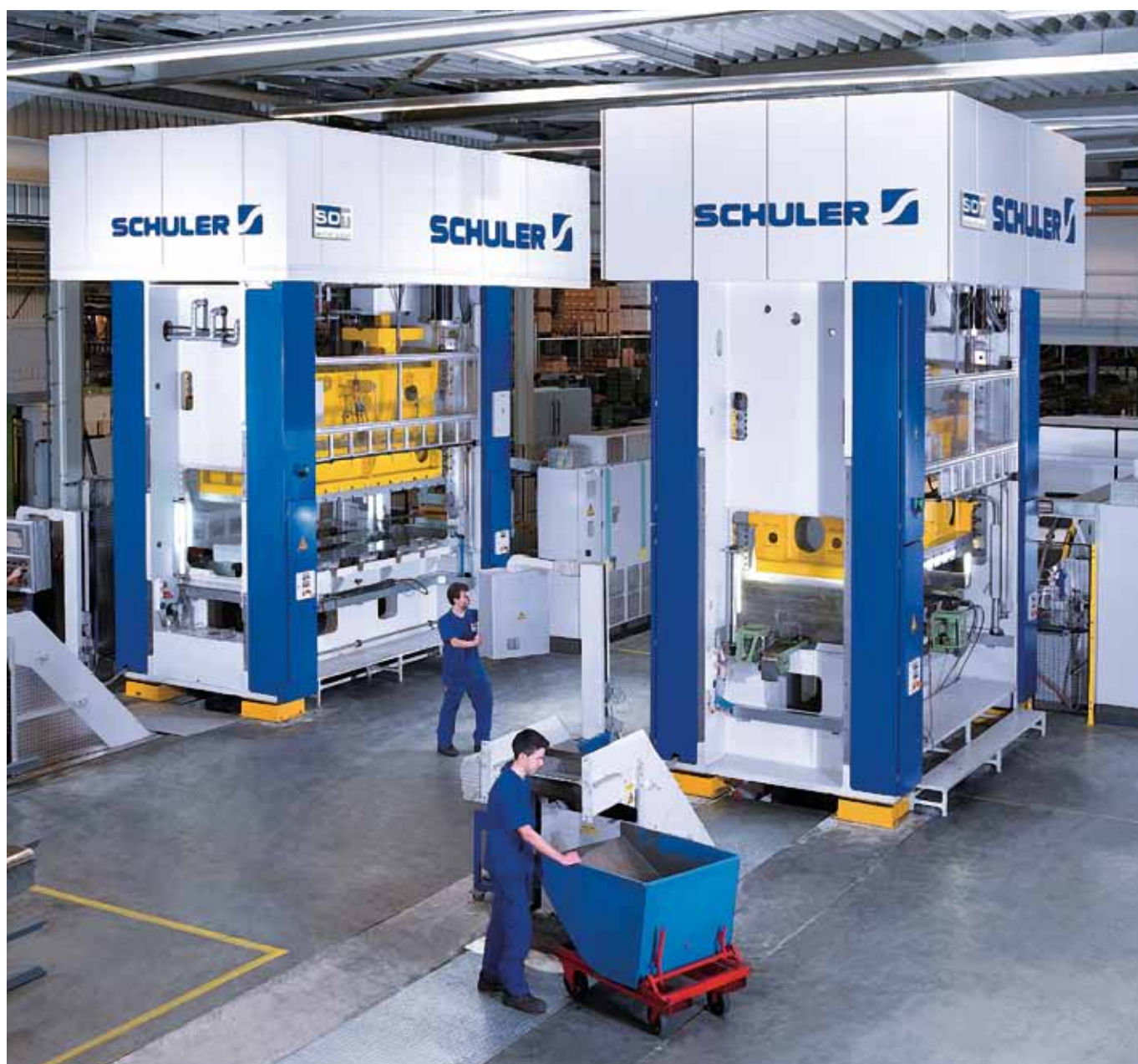
Fabricación flexible con servoprensas de estructura monobloque. Fuerza de prensado: 4.000 kN.
