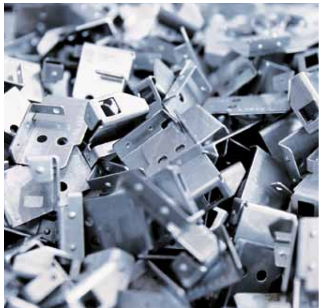
Piezas estampadas en masa, producidas con servoprensa de estructura monobloque, fuerza de prensado: 2.500 kN.
