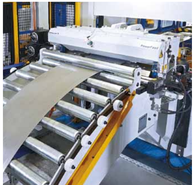
Unidad de rodillos de avance de alto dinamismo «Power Feed».
