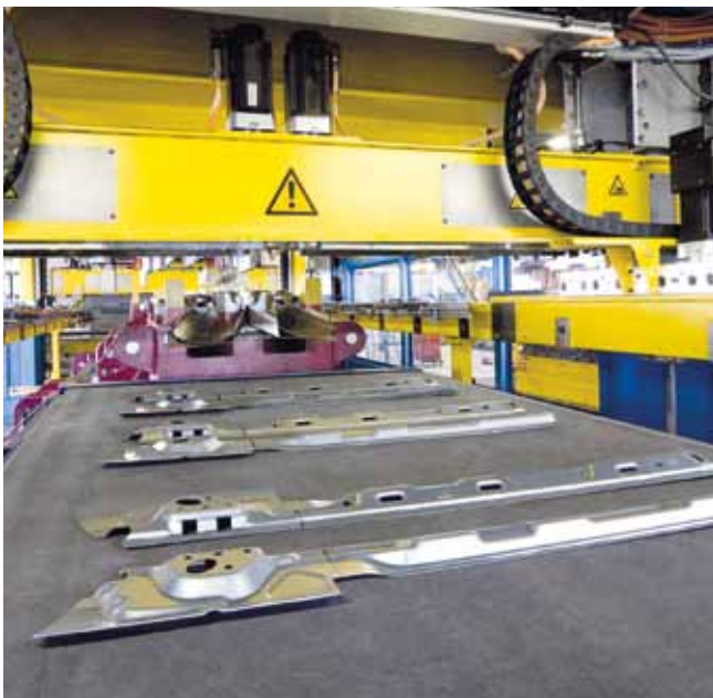
Fabricación en serie con servoprensa de estructura de tensores, fuerza de prensado: 16.000 kN.
