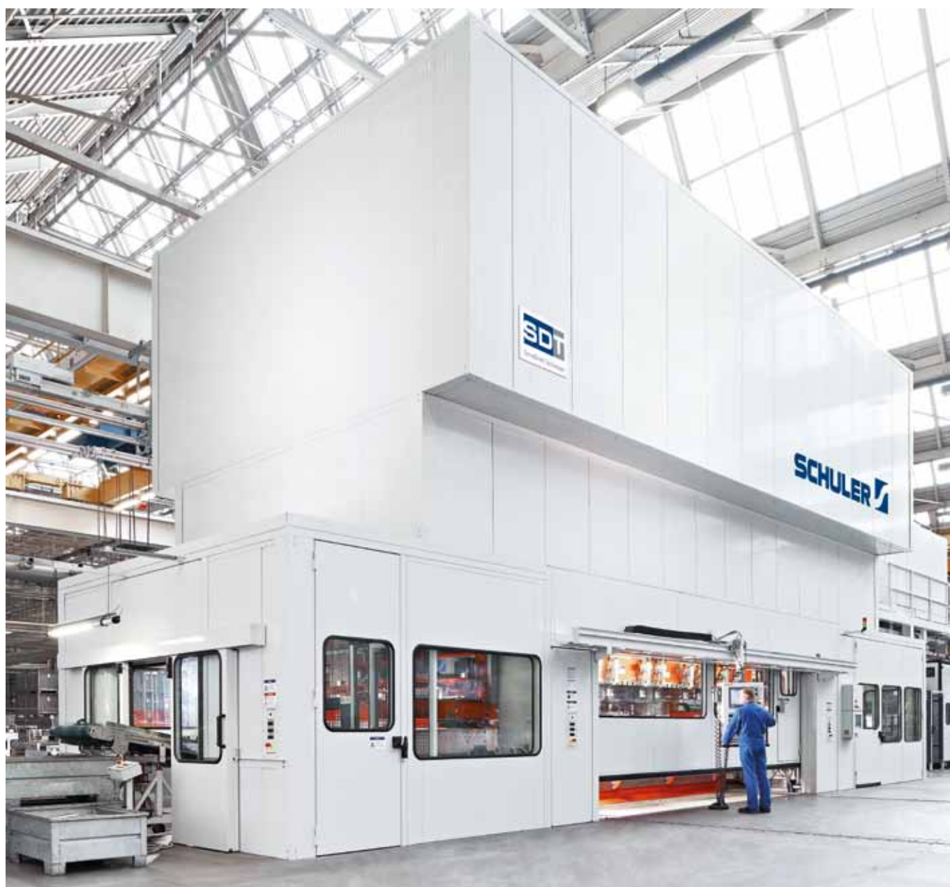
Servoprensa de estructura tirantes empleada por un fabricante de aparatos domésticos. Fuerza de prensado: 16.000 kN.
