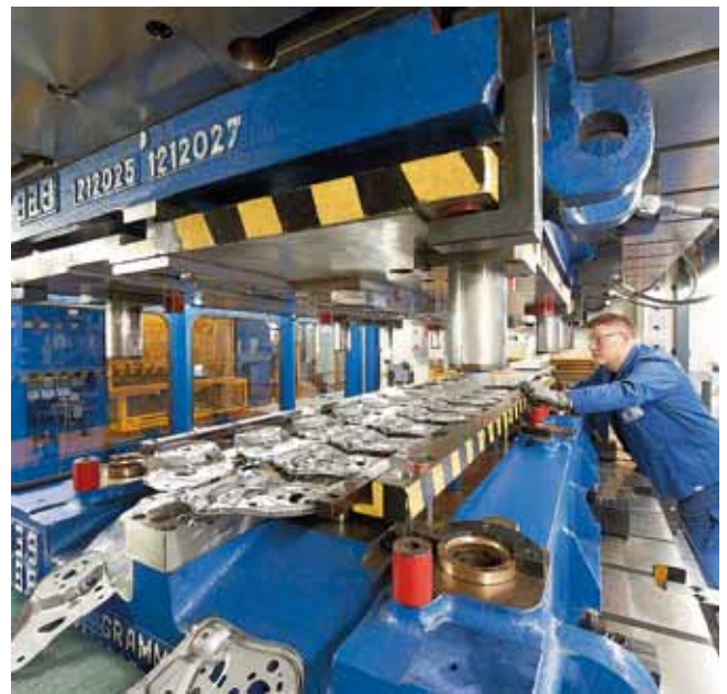
Fabricación en serie con servoprensa en estructura de tensores, fuerza de prensado: 8.000 kN.
