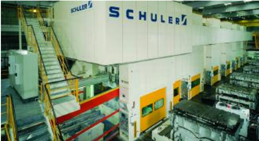
Die Hybridlinie: Mechanische Pressenlinie mit neuer hydraulischer Kopfpresse.
