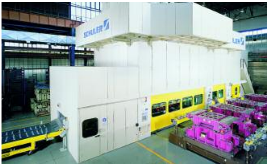
Mechanische Zweistößel-Transferpresse mit sechs Stufen zur Verarbeitung hoch- und höherfester Stähle, Gesamtkapazität 45.000 kN.
