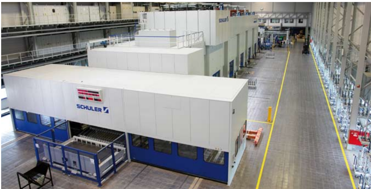
Hydraulische Pressenlinie mit Platinenlader und Roboterautomation. Gesamtkapazität 89.000 kN
