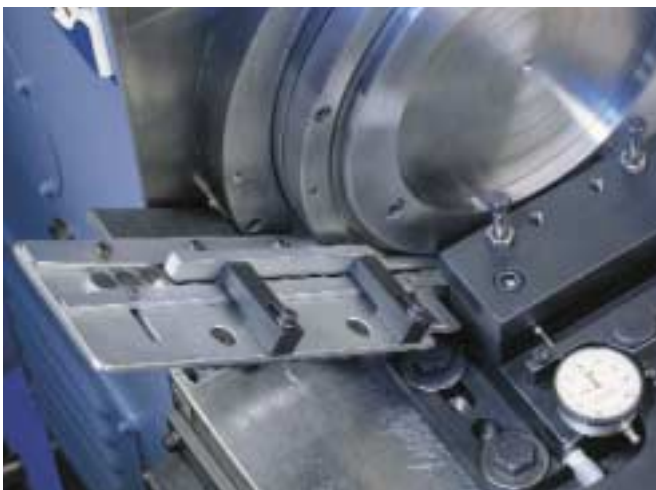
Für die Randgestaltung von Platinen besonderer Qualität kann ein Handeinlegekanal angebaut werden.
