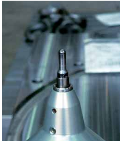
Klopfkopf für das Festklopfverfahren.
