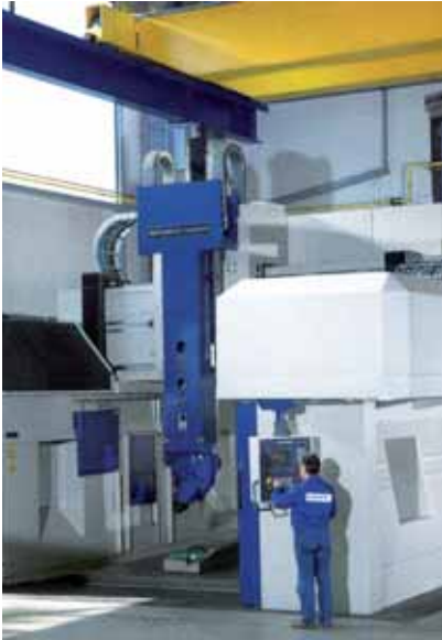
Fünf-Achsen-Portal HSC-Fräsmaschine im IHU-Technologiezentrum in Wilnsdorf.
