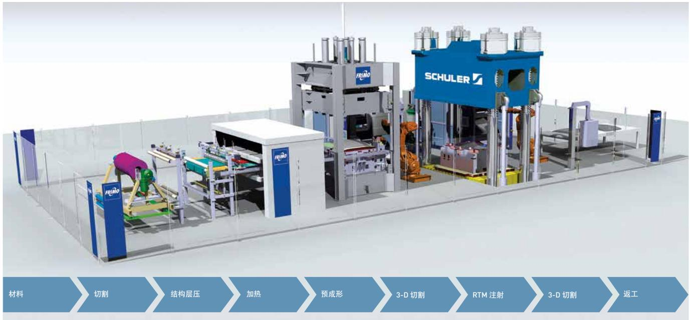
用于生产 RTM 部件的模块化生产线
